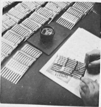
Lackierarbeiten am Innenwerk varnishing of internal parts
