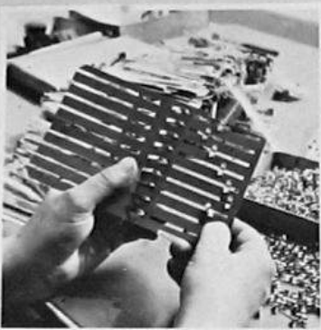
Jeder Zahlenschieber wird mit Klammern am Rast befestigt attachment of figure-slides to grit
