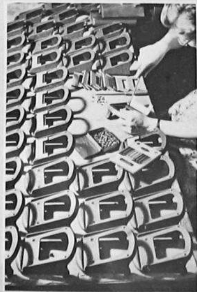
Anschrauben der Schwenkstücker auf die Sockel • mounting of hinged holders on cast base
